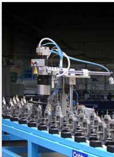
**alkitronic® CLV** en un pre-montaje y en un montaje final en servicio semiautomático. Un control neumático externo controla el atornillado continuo.
